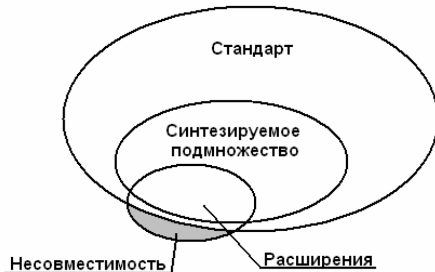
Рисунок 3.1 - Соотношение между подмножествами конструкций в языках описания аппаратуры.
